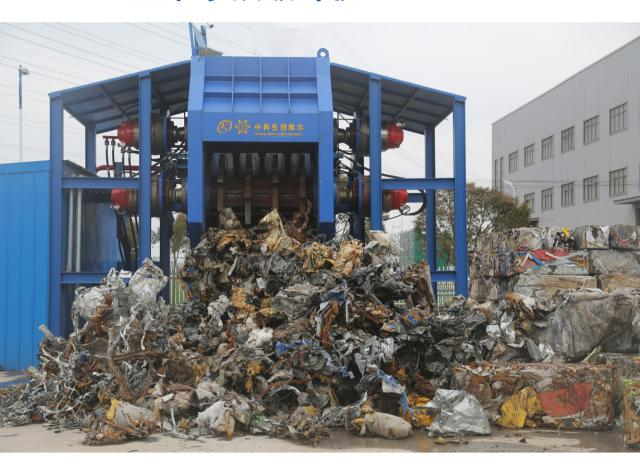
预破碎机是由高速转子、低速转子、侧压料板、驱动装置、机体支撑框架等部件组成。 两个转子由液压驱动,相互独立控制,可实 现正反转,产生拉伸及撕扯作用。
